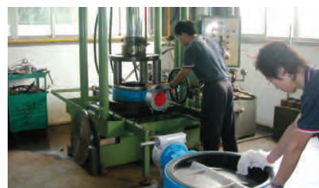
大型蝶閥試壓設備
